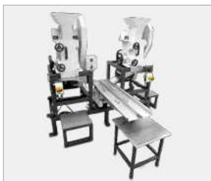
訂製機種： BB250XL兩台加上樣品自動分樣裝置設計
