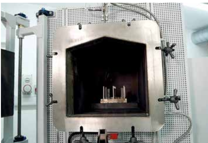
圖2: 打開爐門直視GPCMA/174積層製造之樣品的應力緩解構造。
