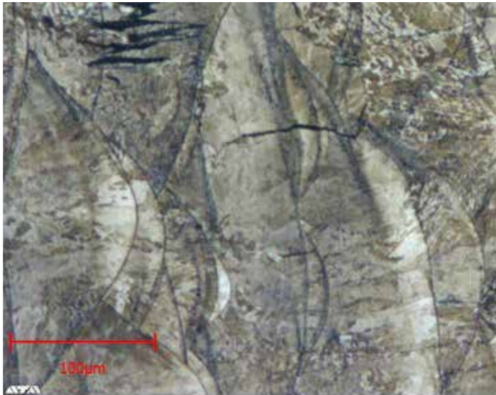
圖 8: 對比試片。所製造工件的焊接微觀結構清晰可見。
