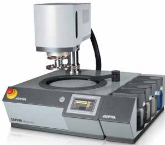
圖 5. 半自動研磨拋光機 Saphir 250 A1 Eco
