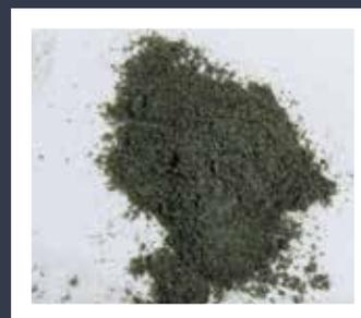
3 PULVERIZATION IN THE CRYOMILL TO 200 µM
